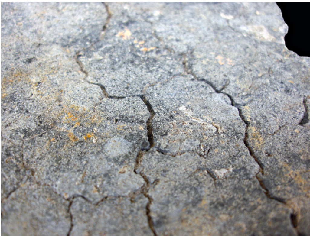
4. kép. Száradási repedések a felületen
