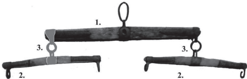
5. kép. A hámfavasak alkalmazásának módja négylovas hámnál. Hátsó, közös hámfá, kiséfa (1), első hámfák (2), hámfá vasak (3)
